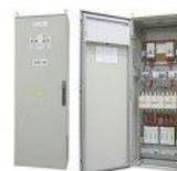
**Пункт распределительный ПР, ПР11, ПР8501, ПР8503:** предназначен для распределения электроэнергии, защиты электрических установок напряжением до 660 В переменного тока частотой 50 и 60 Гц при перегрузках и коротких замыканиях, а также для нечастых (до 3-х включений в час) оперативных коммутаций электрических цепей и прямых пусков асинхронных двигателей.
